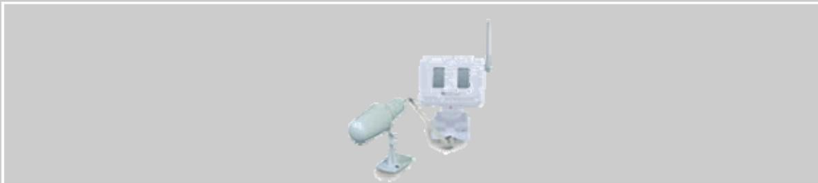
Ogni sensore è collegato WireLess all'unità centrale lavorando alla frequenza di 433 Mhz ed alimentato da un'unità a cella solare fotovoltaica per alimentare la trasmissione radio. L'unità centrale a sua volta è predisposta per una connessione ad elaboratore attraverso una porta seriale RS-232.
