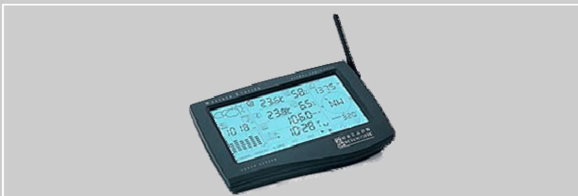
Dispone di un sensore termometro, barometro, igrometro interno:
