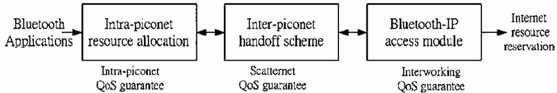
Figura 2.9 - Blocchi del QoS-centric cascading
