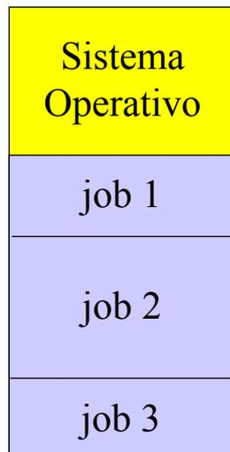
Configurazione della **memoria centrale** in sistemi batch multiprogrammati
