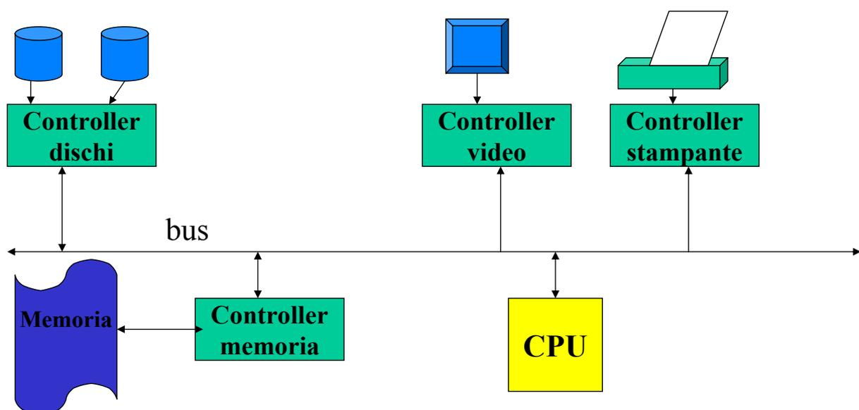
**Controller:** interfaccia HW delle periferiche il bus di sistema
