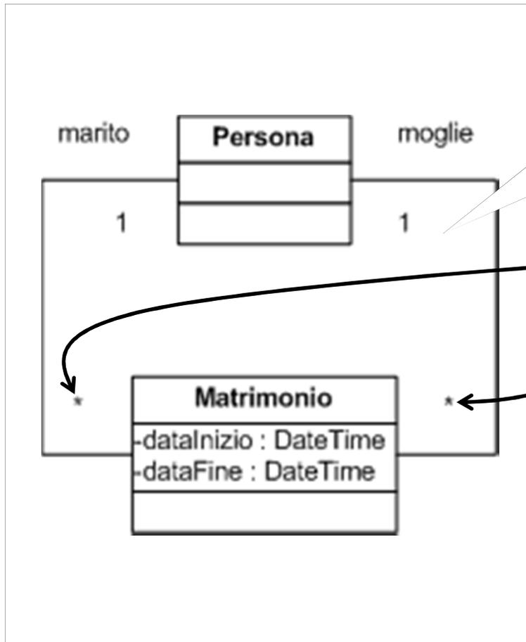
Modello equivalente al precedente in cui la classe associazione è stata concretizzata in una classe normale (da usare solo in **progettazione**)
