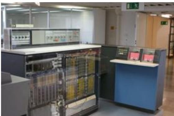
*Macchina IBM System 360. Sulla destra due lettori di punch card multi-funzione*
