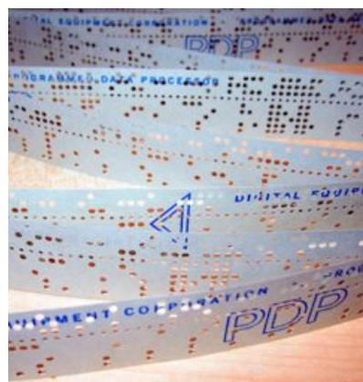
*Punch-tape per la Macchina PDP-11 della Digital Equipment Corp.*
