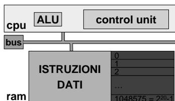
**L'unità di controllo** fa funzionare l'elaboratore. Da quando viene acceso a quando è spento, essa esegue in continuazione il ciclo di *prelievo / decodifica / esecuzione (fetch / decode / execute)*.
