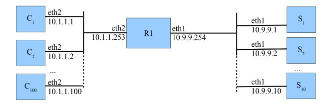
Di norma, i client sono raggruppati in 10 blocchi di 10 macchine con indirizzi consecutivi, e ogni blocco è servito da un server. LDAP è utilizzato per memorizzare statistiche di utilizzo dei client, che caricano dati periodicamente.
